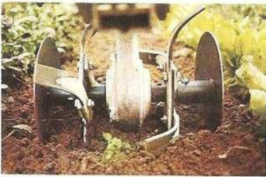
Changement de largeur sans clef ni tourne- vis. Ci-dessus : 2 étoiles pour binage étroit.
