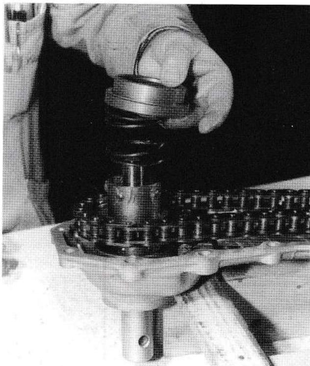
**131.** Les billes étant dans leur logement, retenues par la graisse, mettez en place le ressort et la bague supérieure de déclabotage.
