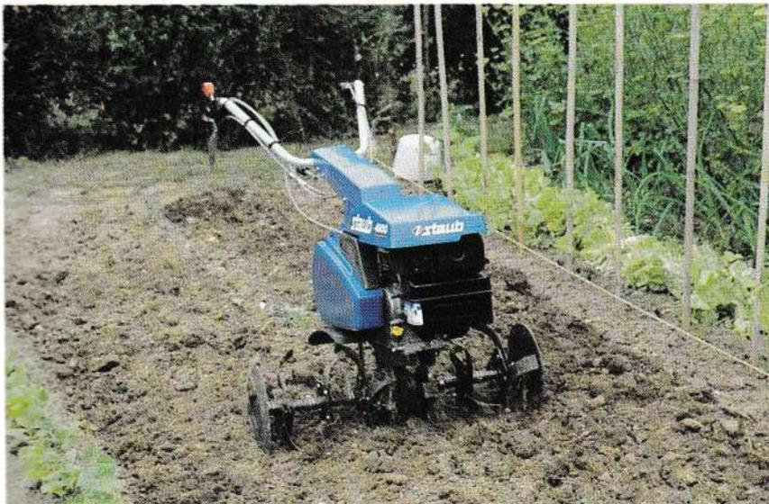
Le HONDA F 560, autre motobineuse transformable de la 3e famille dans sa version fraises ventrales. Le modèle HONDA F 520 fait partie de la 2e famille des motobineuses. ▼
