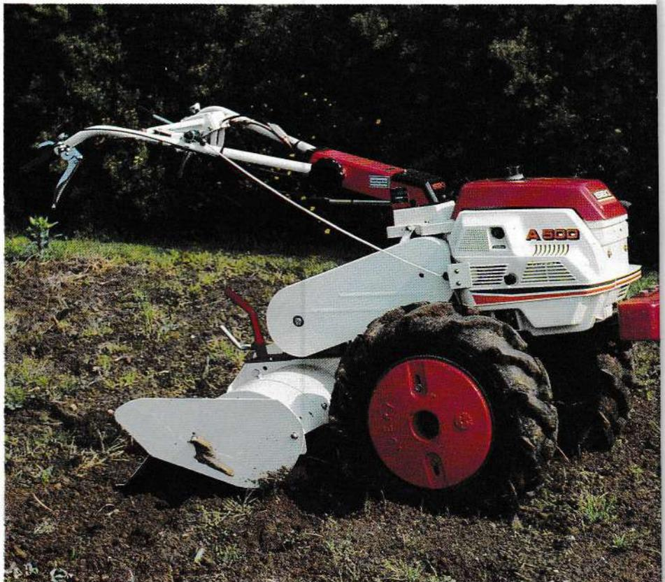
Motobineuse transformable avec commandes de décrabotage des roues et prise de force latérale l'ISEKI A 500 peut prétendre au titre de "motoculteur". Equipé de roues de 6.0x12 et d'une fraise arrière, ce motoculteur sera rarement transformé en motobineuse compte tenu du poids de ses masses.
