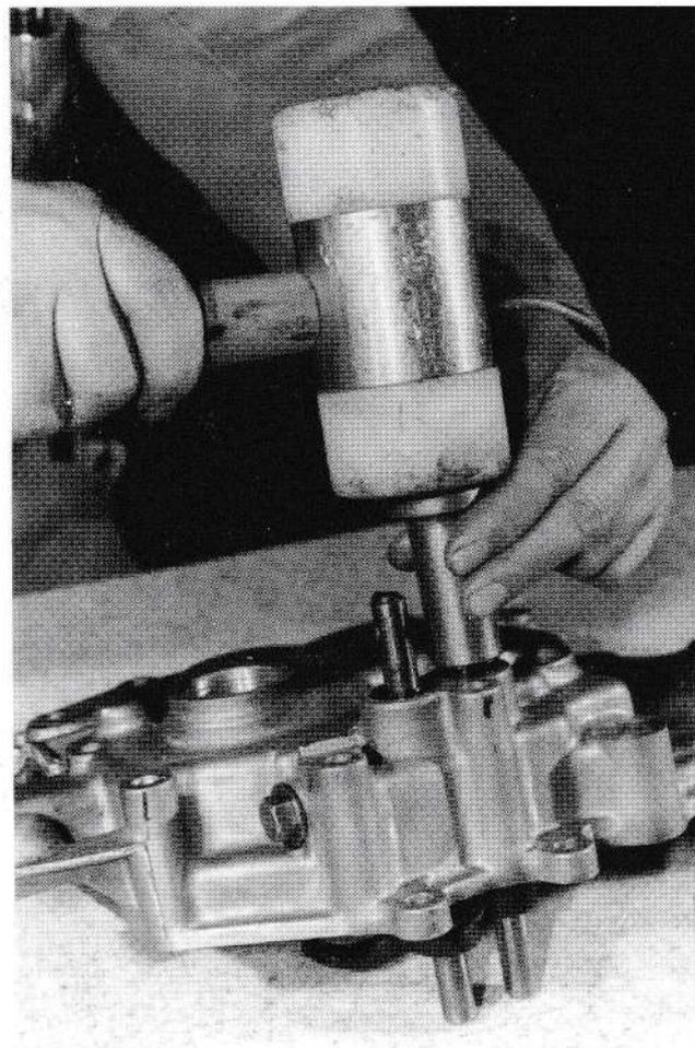
**118.** A l'aide d'une douille creuse de diamètre approprié, enfoncez les bagues d'étanchéité dans leur logement jusqu'à fleur de carter.
