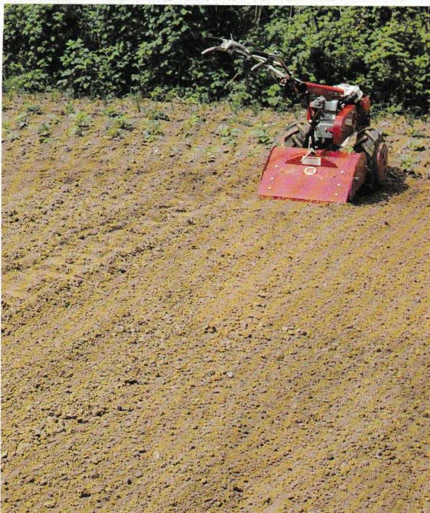
Ci-dessus un motoculteur avec fraise arrière (ou sardo-fraise) en action. Avec le guidon déporté on évite de piétiner la terre fraîchement émietlée. On peut obtenir un lit de semence encore plus fin en réglant la béquille de tarrage plus haut.
