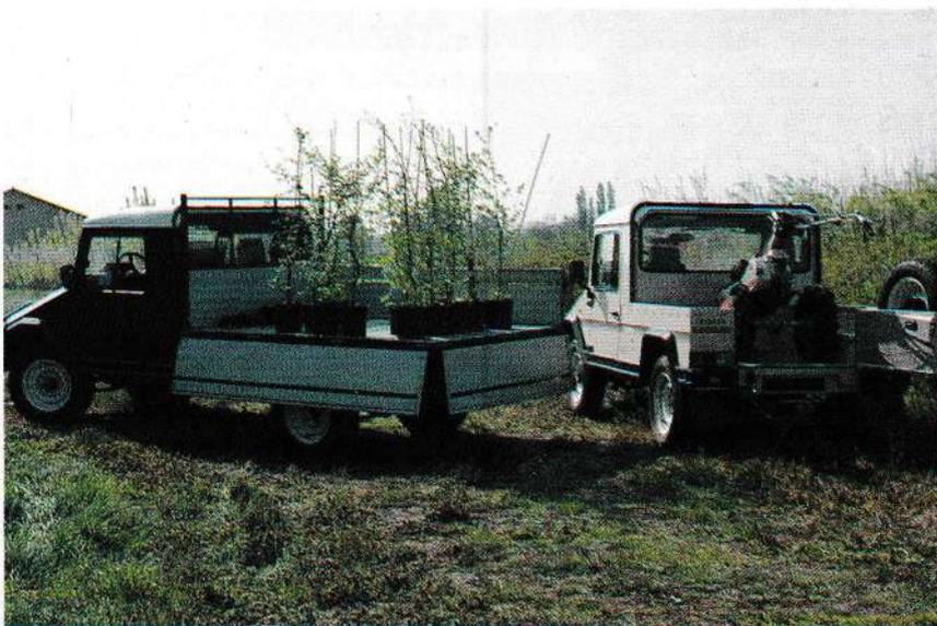
angle d'attaque de 48°. Par contre si le châssis court à une possibilité de franchissement en angle inférieur à 38°, le châssis long est pénalisé à 28°. Mais le châssis long est déjà un vrai utilitaire plus adapté au "tout-chemin" qu'au "tout-terrain", a conseiller donc aux "PROS" du jardin plus qu'aux forestiers !
