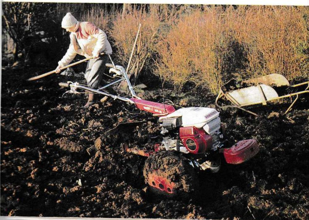
La charrue "NIP" effectue des labours à plat comme un brabant bien que ne comportant qu'un soc. Ce soc, étant basculable autour de l'étauçon, permet de verser la terre successivement d'un côté ou de l'autre tout comme un brabant.
