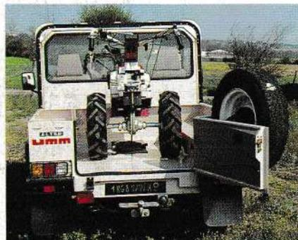
Malgré les importants passages de roues le châssis court accueille la plupart des motoculteurs sans problème, il bénéficie d'un seuil de chargement relativement bas pour un 4x4. Par contre, ci-dessous, le châssis long voit son seuil réhaussé mais son plan de chargement qui passe au-dessus des roues est nettement supérieur.
