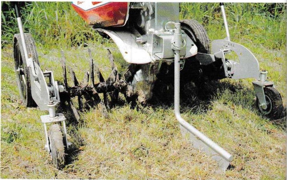
Ci-dessus gros plan du scarificateur sur un terrain herbeux présentant une consistance idéale, ni trop humide, ni trop dure. On remarque que les couteaux pénètrent dans la terre sans la labourer réalisant ainsi une aération maximum.
