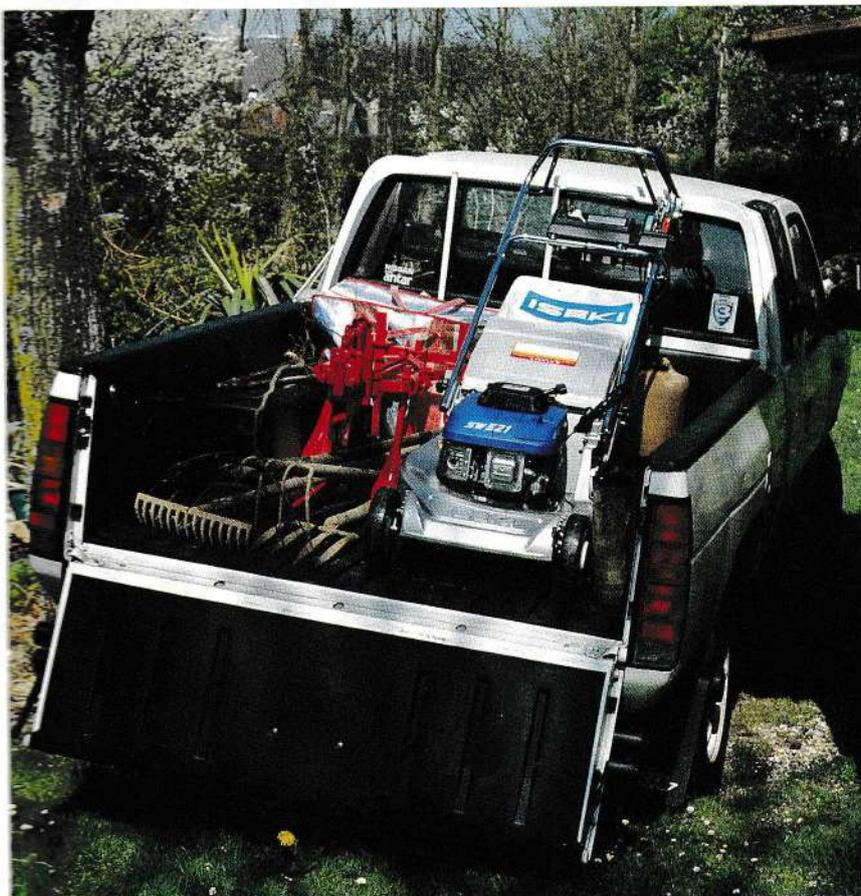
Le pick-up KING CAB dans sa version bac plastique, permet de recevoir des outils aux arrêtes vives, tels les socs de ce cultivateur rouge, à gauche, sans dommages pour le plancher d'origine en tôle. On évite ainsi l'installation précoce de la rouille.
