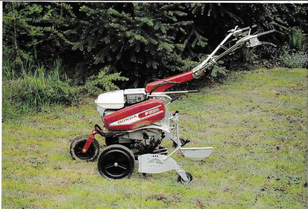
Déchaumage de printemps avec le scarificateur AEROSCAR des FORGES des MARGERIDES. Les petites mottes de matières végétales mortes peuvent être enlevées en passant dessus une tondeuse équipée de son sac récupérateur.
