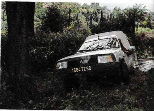
Ci-dessus. La manœuvre de franchissement présentée ici n'a été possible que grâce à l'option "blocage différentiel arrière" dont était équipé ce C15.
