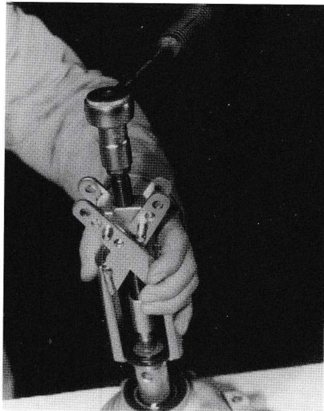
**ÉCHANGE D'UN JOINT D'ARBRE DE ROUE SANS DÉMONTAGE**
