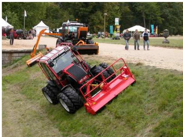
« Les tracteurs de pente tels que les Reform » munis d'un équipement de débroussaillage sont de plus en plus utilisés sur les chantiers routiers. Photojcd Salonvert06
