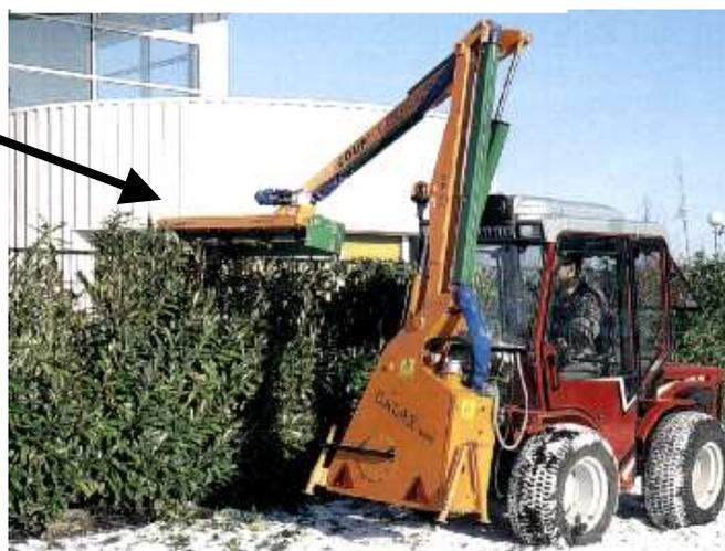
**Ce petit lamier "Kirogn" est adaptable sur un automoteur porte-outils, mais aussi sur "le trois points" d'un microtracteur**
