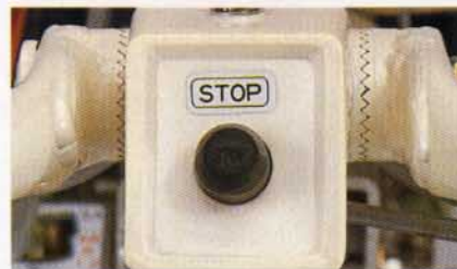
Bouton d'arrêt-moteur électronique aux mancherons
