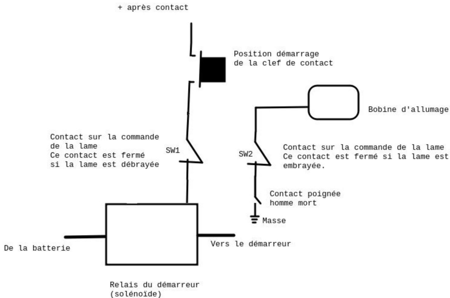
Les deux contacts de sécurité SW1 et SW2 sont activés ou désactivés par la commande d'embrayage de la lame. Si la lame est débrayée le contact SW1 est fermé et le relais du démarreur peut être alimenté par la clef de contact en position démarrage et le moteur lancé. Si la lame est embrayée le contact SW1 est ouvert et le relais du démarreur ne peut plus être alimenté.
