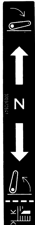
Levage hydraulique PIECE NO: 390372541 EMPLACEMENT: Grille de commande droite
