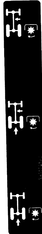
Sélection de la prise de force PIECE NO: 390174191 EMPLACEMENT: Grille de commande gauche
