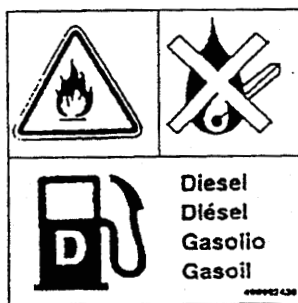
Carburant diesel PIECE NO: 490992430 EMPLACEMENT: Près du bouchon du réservoir de carburant
