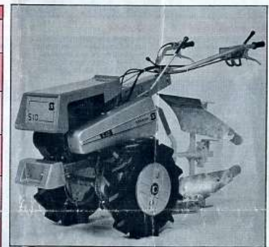
S 10 cellule motrice avec équipement labour.
