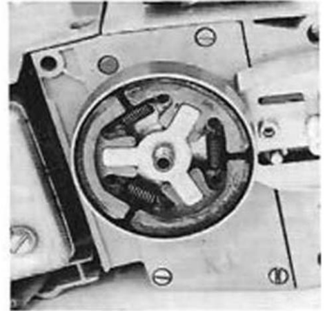
Pignon de chaîne, embrayage avec araignée, mâchoires d'embrayage et ressorts d'embrayage
