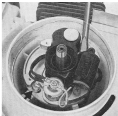
Dévissage du stator d'allumage
