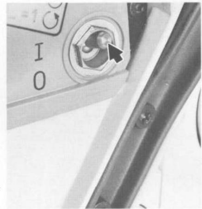
Interrupteur de chauffage sur "I"
