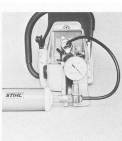
Configuration de test avec pompe à vide 0000 850 3500
