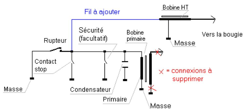
Allumage à rupteur par volant magnétique et bobine HT extérieure
