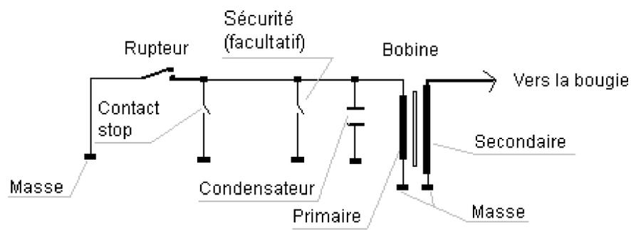
Allumage à rupteur par volant magnétique
