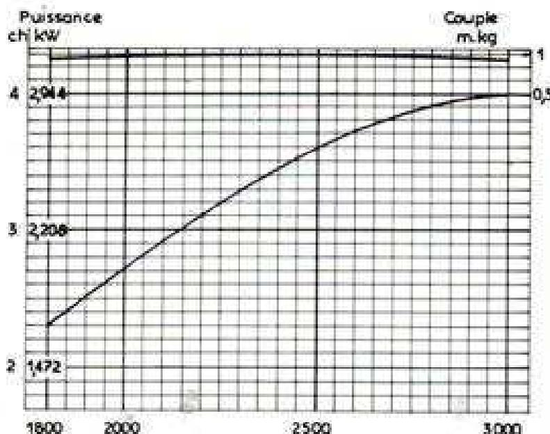
"Les puissances sont indiquées en service continu pour des moteurs sans pot d'échappement, sans filtre à air et sont garanties avec une tolérance de  $\pm 5\%$  après rodage".
