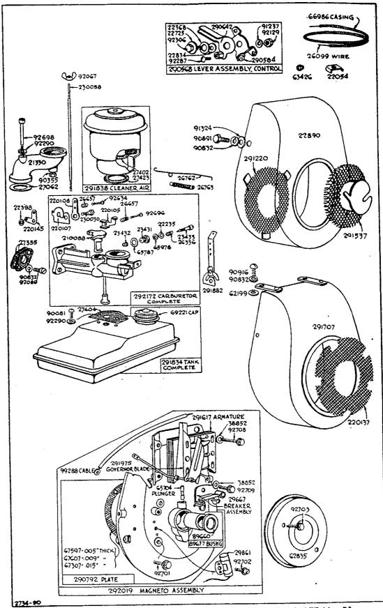
FUEL SYSTEM, BLOWER CASE AND IGNITION PARTS — PLATE No. 21
