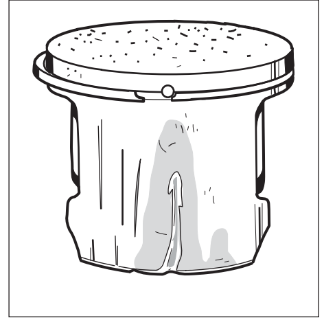
Rainures irrégulières sur le côté aspiration du piston causées par la cage à billes brisée.
