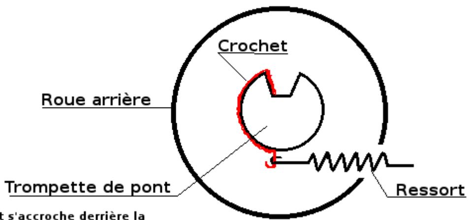
Le ressort s'accroche derrière la roue arrière droite du tracteur.
