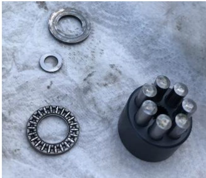
barillet de pompe principale
