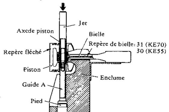
Engager le jet dans l'axe de piston et visser le guide A au jet.
