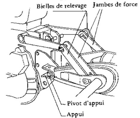
1. Déterminer la position verticale de la rotobineuse pour que les appuis se trouvent à la hauteur des pivots d'appui de l'attache 2 points située à l'extrémité arrière du tracteur.
