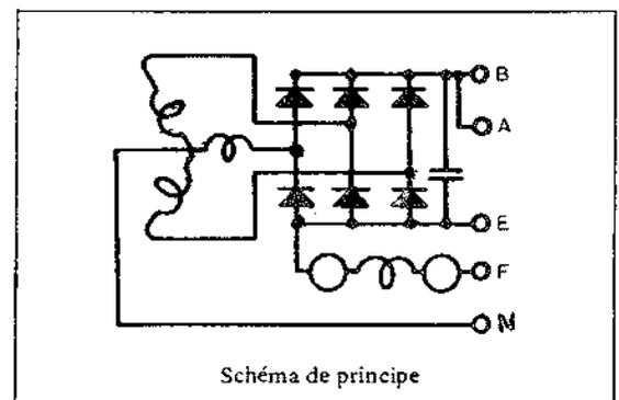
Il s'agit d'un alternateur triphasé à pont redresseur à 6 diodes. Il est entraîné par la courroie du vilebrequin. Il se compose d'éléments fixes et tournants. Les éléments tournants sont le rotor ou inducteur, les roulements, la poulie avec le ventilateur,...
