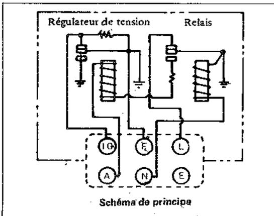
L'appareil se compose du régulateur de tension et du relais de témoin de charge. Son branchement se fait au connecteur. Le régulateur maîtrise la tension fournie par l'alternateur, quelle que soit la vitesse de celui-ci. En fait, il permet de régulariser la tension fournie par la génératrice, en coupant et en rétablissant le courant dans les bobinages.
