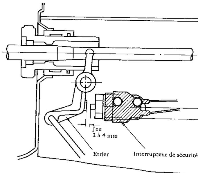
Cette mise au point achevée, voir si l'embrayage obéit bien. Si le tracteur doit être immobilisé pendant une assez longue période, immobiliser le pédalier en position débrayée.
