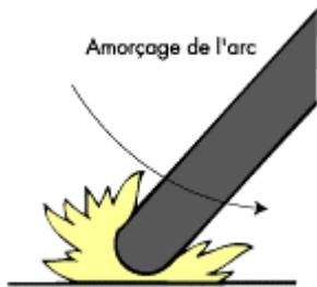
**1** - Le visage protégé par le masque de soudage, frotter le bout de l'électrode sur la pièce à souder sur 1 ou 2 cm, ce qui produit des étincelles.
