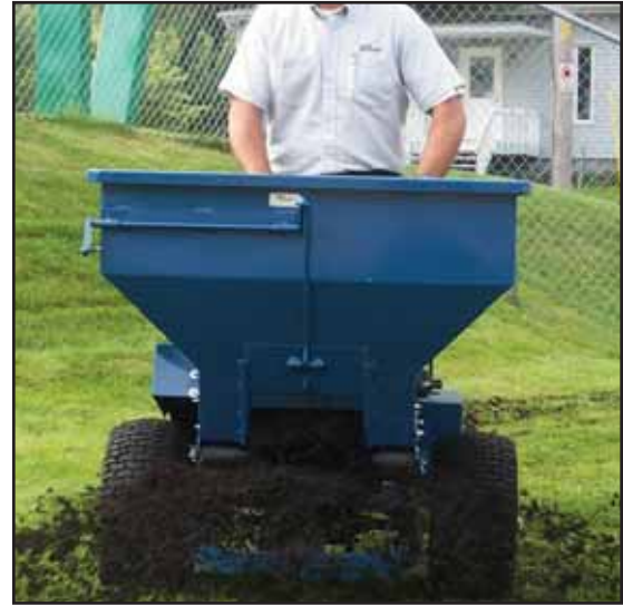
Figure 6. Application d'un terreau à l'aide d'un épandeur mécanisé (photo : L. Roberge, Fertil Plus)
