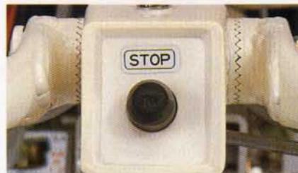
Bouton d'arrêt-moteur électronique aux mancherons
