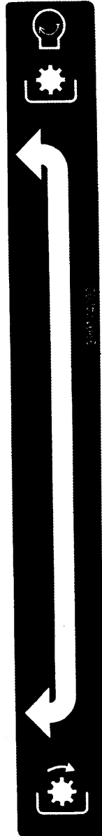
Engagement de la prise de force PIECE NO: 390174201 EMPLACEMENT: Grille de commande droite
