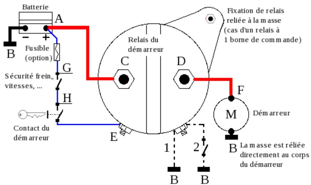
Cas d'un relais avec 2 bornes de commande
