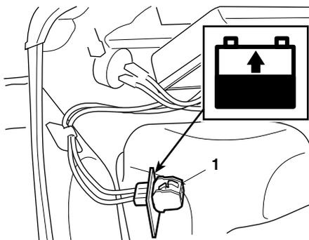
au connecteur correspondant du chargeur de batteries de maintien prévu à cet effet "CB 01" fourni (▶ *si prévu*) ou disponible sur demande (☛ 8.5).
