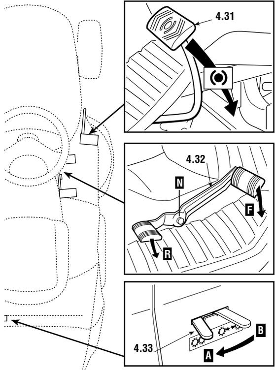
**⚠ ATTENTION!** *Le passage de la marche arrière doit être effectué quand la machine est à l'arrêt.*
