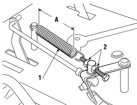
**A** = 119 - 121 mm (▶ dans les modèles à transmission mécanique)
