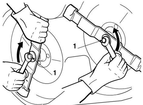
d'une meule à grain moyen et vérifier l'équilibrage de la lame en la soutenant avec un rond Ø18 mm enfilé dans le trou central.
