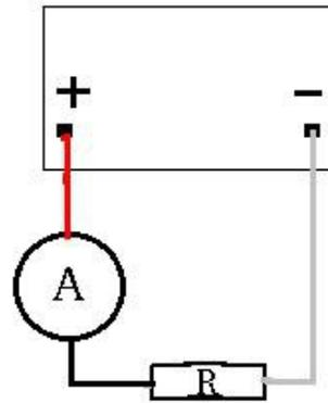
Mesure d'un courant le multimètre est en série avec la charge R
