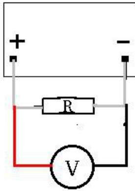
Mesure d'une tension le multimètre est en parallèle sur la charge R
