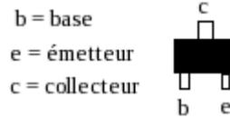
Avec l'ohmmètre sur le plus petit calibre de résistance :
