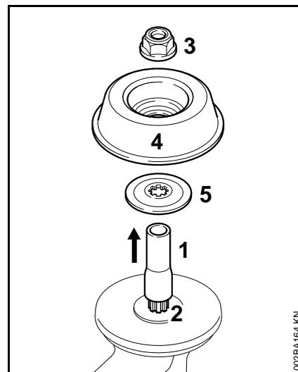
Suivant la version de l'outil de coupe, il faut utiliser en outre l'écrou (3), le bol glisseur (4) et le disque de pression (5).
