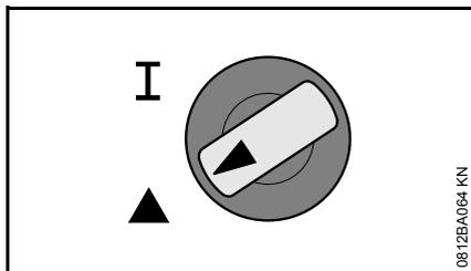
**Position de marche normale I** – c'est dans cette position que l'on démarre le moteur chaud et que le moteur fonctionne normalement.
