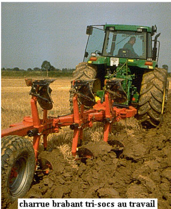
La roue avant et arrière du côté versement, passent dans le sillon, mais la charrue doit rester pratiquement perpendiculaire au sol. Les grosses charrues brabant ont un système de retournement hydraulique
