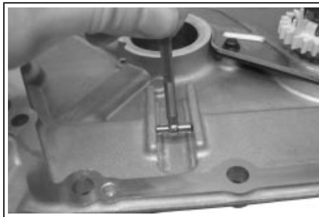
Figure 9-7. Mesure de la largeur du canal de guidage de la plaque de fermeture.
