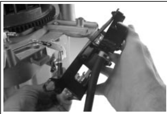
Figure 8-17. Déconnexion du ressort du régulateur.
