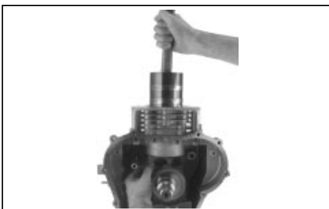
Figure 10-18. Installation du piston et de la bielle.
