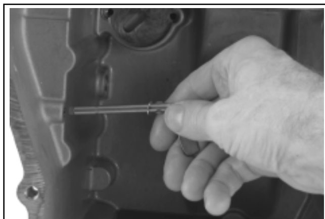
Figure 8-53. Dépose de l'arbre intermédiaire du régulateur.
