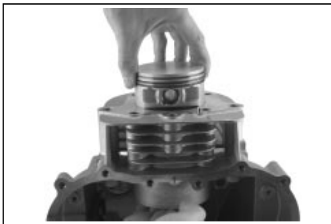
Figure 8-45. Dépose du piston et de la bielle.
