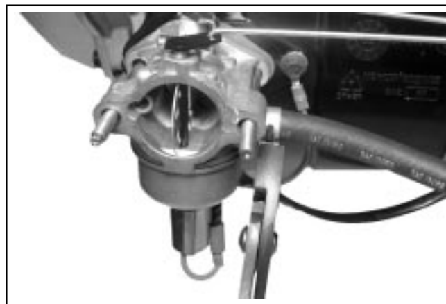
Figure 10-58. Branchement de la canalisation du carburant sur le carburateur.
