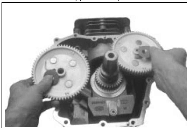
Figure 8-39. Dépose des engrenages à cames.
