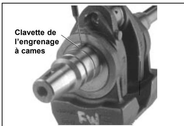
Figure 10-13. Installation de la clavette de l'engrenage à cames.
