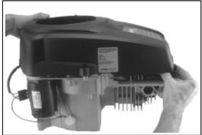
Figure 10-70. Installation du carter du ventilateur.
