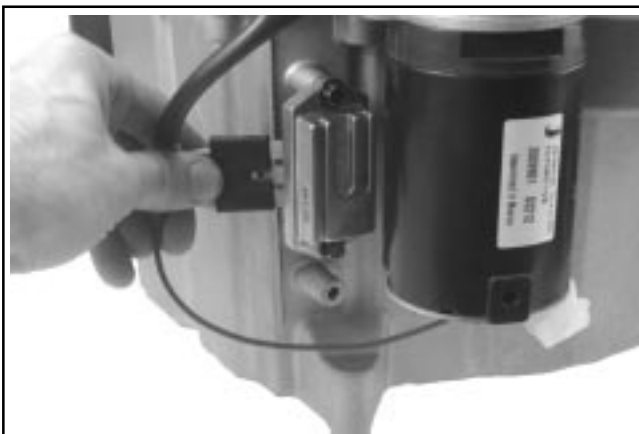
Figure 10-69. Installation du redresseur-régulateur.
