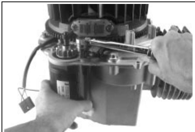
Figure 10-47. Installation du démarreur électrique.
