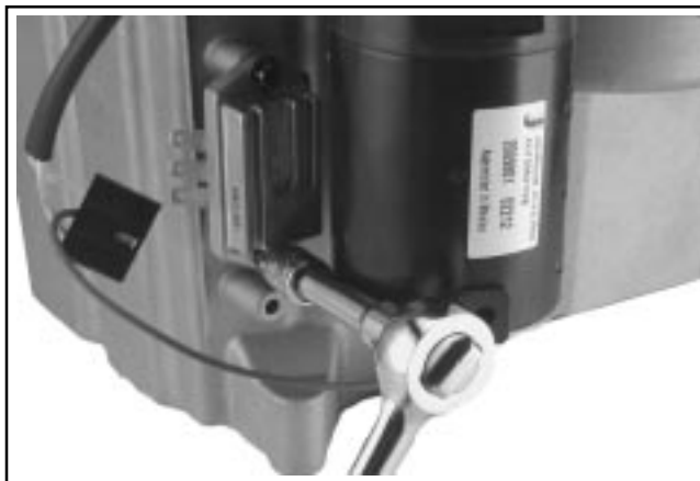
Figure 8-5. Dépose du redresseur-régulateur.
