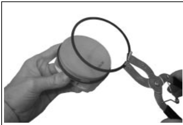
Figure 8-47. Dépose des segments de piston.
