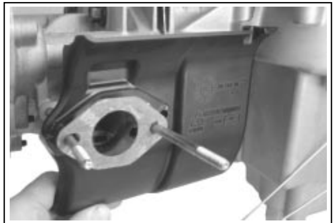
Figure 8-19. Dépose du déflecteur thermique.
