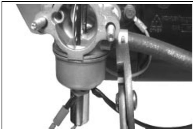
Figure 8-11. Débranchement de la canalisation du carburant du carburateur.
