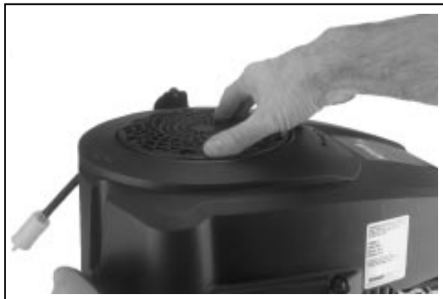
Figure 10-72. Mise en place de la grille de protection contre l'herbe.
