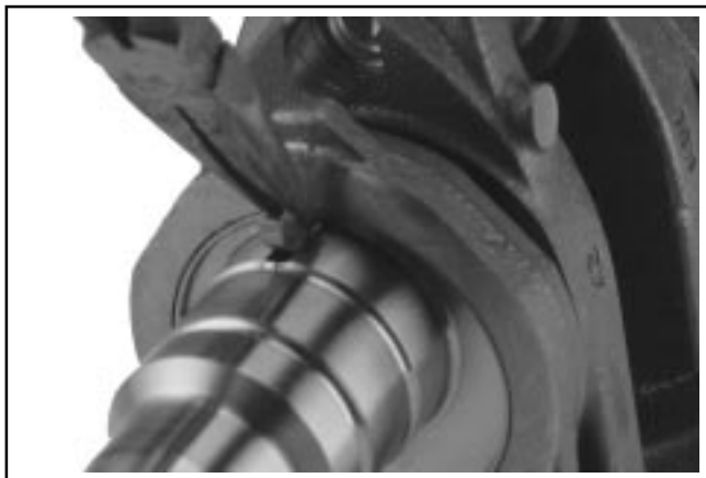
Figure 8-49. Dépose de la clavette de l'engrenage à cames.
