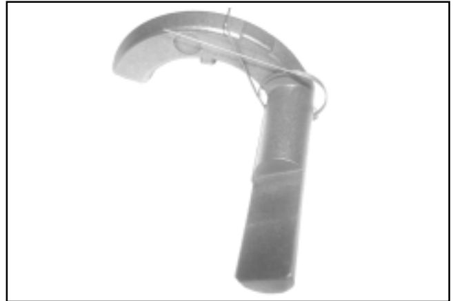
Figure 10-23. Ressort installé sur la masse du décompresseur automatique.
