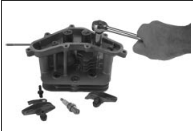
Figure 8-33. Démontage des composants du culbuteur.
