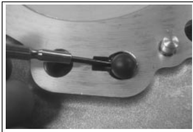
Figure 8-31. Dépose du drain du carter.
