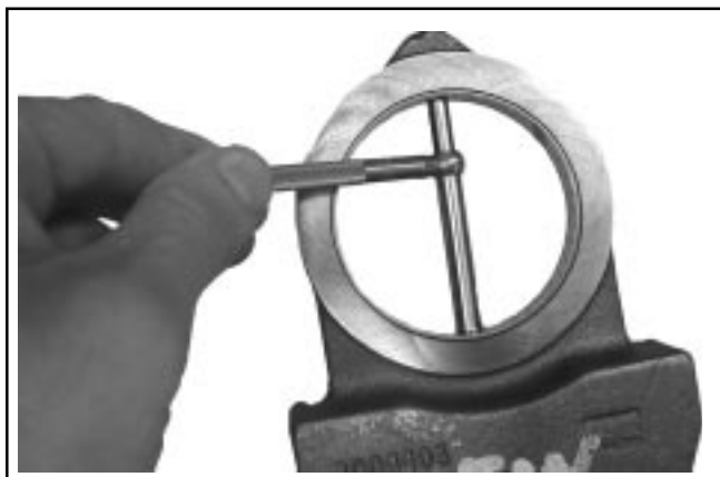
Figure 9-4. Mesure de la surface de support de la masselotte.
