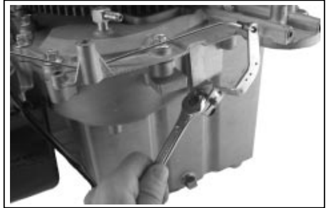
Figure 8-18. Dépose du levier du régulateur.
