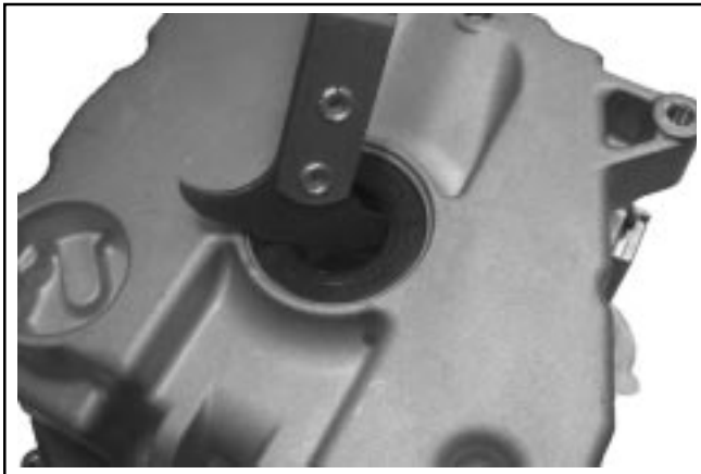
Figure 8-54. Dépose du joint avec un extracteur de joint.
