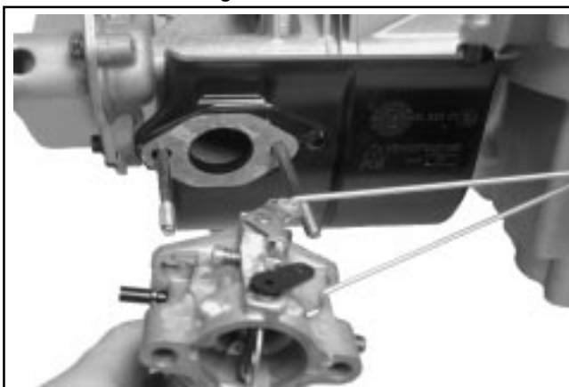
Figure 8-15. Dépose du carburateur.
