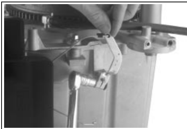
Figure 5-22. Serrage de l'écrou du levier du régulateur.
