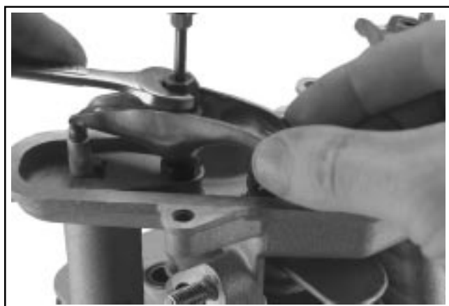
Figure 8-28. Desserrage des vis et écrous de réglage.
