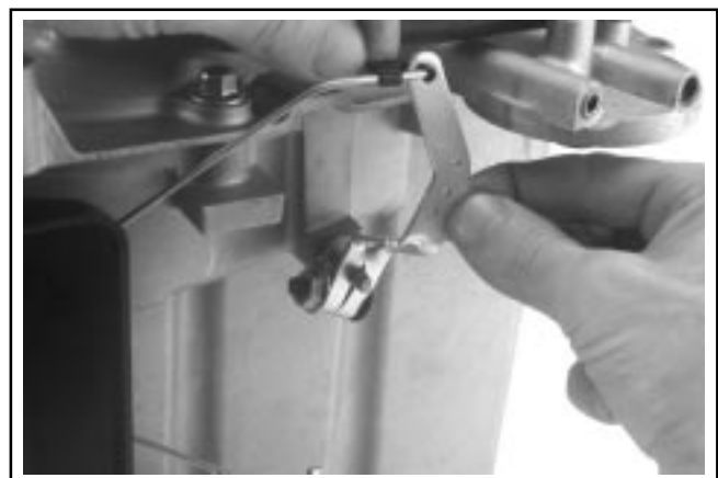
Figure 10-63. Levier du régulateur installé sur l'arbre.
