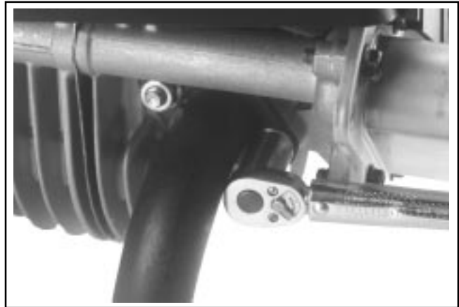
Figure 10-78. Serrage des écrous du système d'échappement.
