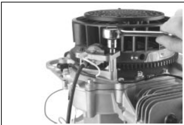
Figure 8-21. Dépose du module d'allumage.
