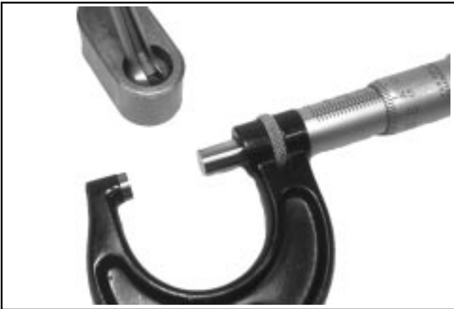
Figure 9-9. Mesure du diamètre intérieur des trous du sabot de guidage.
