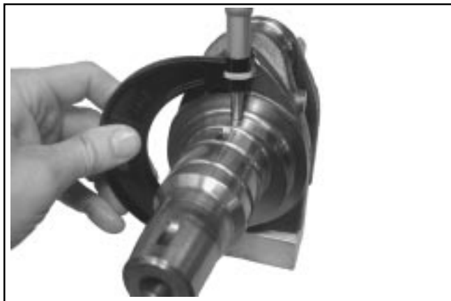
Figure 9-5. Mesure de l'excentrique du vilebrequin.
