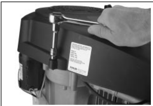
Figure 8-3. Dépose des vis du carter du ventilateur.
