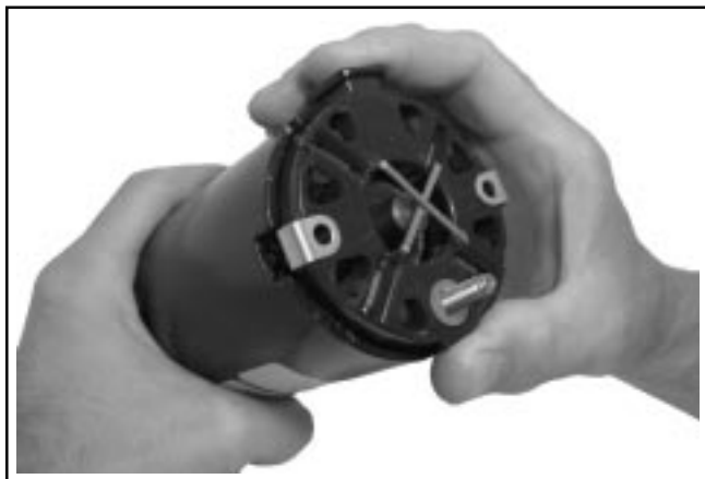
Figure 7-21. Installation du support de balais à l'aide d'agrafes.
