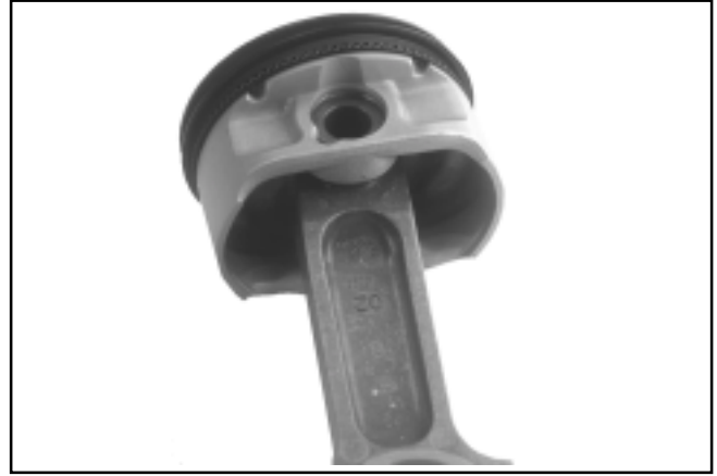
Figure 10-16. Assemblage du piston et de la bielle.
