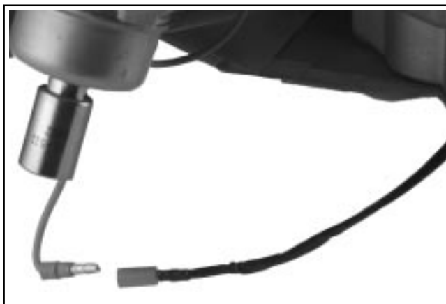
Figure 8-14. Débranchement du solénoïde d'arrêt du carburant.
