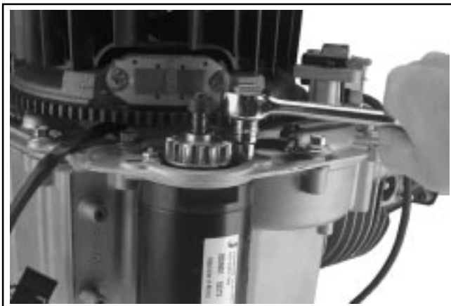
Figure 8-6. Dépose du démarreur électrique.
