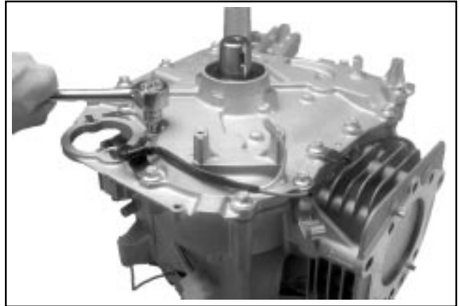
Figure 8-35. Dépose des vis de la plaque de fermeture.
