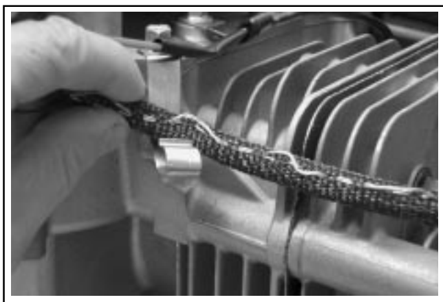
Figure 8-20. Dépose du câble du Clip (RFI Suppression Equipped Units).
