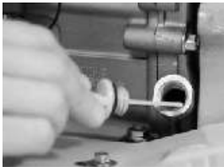
Fig. 4 Ț Verificarea nivelului de ulei al transmisiei
