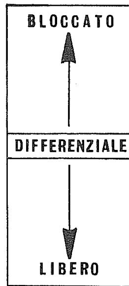
**N.B. - Il bloccaggio può essere effettuato senza disinnestare la frizione e a macchina in movimento, tranne il caso in cui una ruota slitta rispetto all'altra: per evitare urti dannosi all'integrità del bloccaggio stesso, conviene fermare la ruota che slitta disinnestando la frizione. Si consiglia inoltre di non effettuare il bloccaggio del differenziale in prossimità o in corrispondenza delle curve.**
