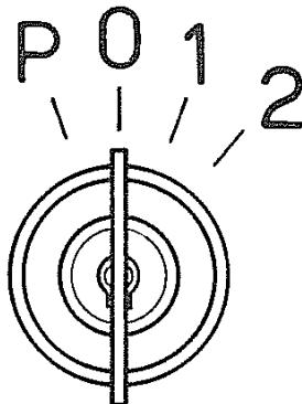
**Avvertenza:** con il motore in moto lasciare la chiave del quadro in posizione **1** (vedi schema) per permettere la ricarica della batteria e il funzionamento dei segnalatori luminosi situati sul cruscotto. A motore fermo ruotare la chiave nella posizione di riposo **0** (vedi schema) per non scaricare la batteria.
