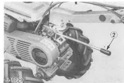
① Levier d'embrayage (A) RAPIDE (B) LENTE (C) DEBRAYAGE ② Levier de changement de vitesses
