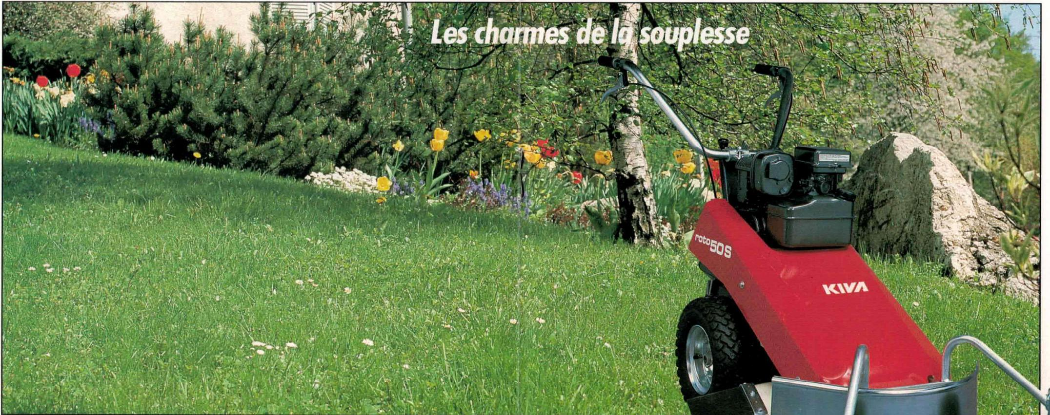
*La ROTO 50 S est capable de couper vite et bien toutes les variétés d'herbes sans limite de hauteur. Elle a l'avantage d'une boîte-pont équipée de 2 vitesses avant et d'un différentiel, ce qui confère à la machine une grande maniabilité et un rendement élevé en toutes circonstances. Idéale pour entretenir votre propriété avec le minimum de contraintes.*
