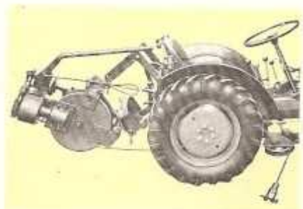
Treuil porté à l'arrière avec un câble de 100 m, 7 mm \phi , pour traction longitudinale et transversale, force de traction env. 1000 kg.
