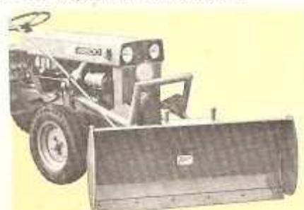
Niveleuse frontale, largeur de travail 100 cm, orientable à gauche et à droite avec patins de profondeur.
