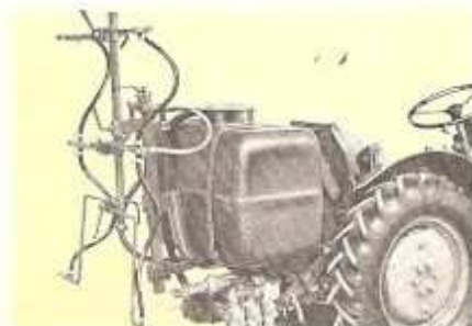
Pulvérisateur monté avec pompe à 3 pistons, débit 44 l/mn., réglage de pression jusqu'à 40 atm., 6 buses disposées en forme de cercle.
