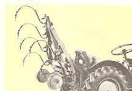
Cultivateur réglable de 80 à 125 cm avec relevage vertical. (Livrable comme équipement spécial).
