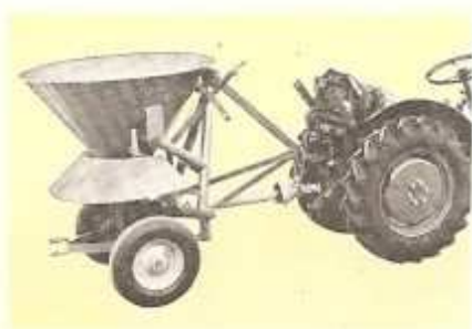
Épandeur d'engrais centrifuge traîné avec dispositif de dosage et rayon d'épandage réglable jusqu'à 8 m, réservoir conique de 165 litres.
