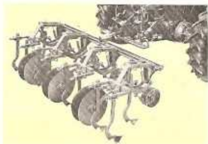
Barre porte-outils variant selon le nombre de rangs et leur espacement, employée pour le sarclage.
